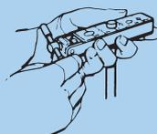
Posicionar el puente sobre la mordaza enfrente del tubo de cobre y apretar
