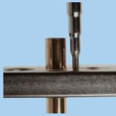
Rohrdurchmesser wird aufgeweitet, wenn Sie den Aufdornstift in das Rohr führen
