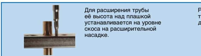
Расширив один конец трубы, вставьте в него другую трубу и запаяйте.
