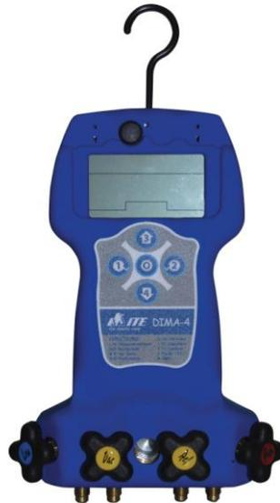
Nous sommes heureux de vous présenter notre nouveau manifold digital **DIMA-4**. Ce manifold digital de haute qualité est adapté pour une utilisation avec des sondes thermocouples de type K. Chaque manifold est livré avec une batterie de 9V (40 heures d'autonomie).
